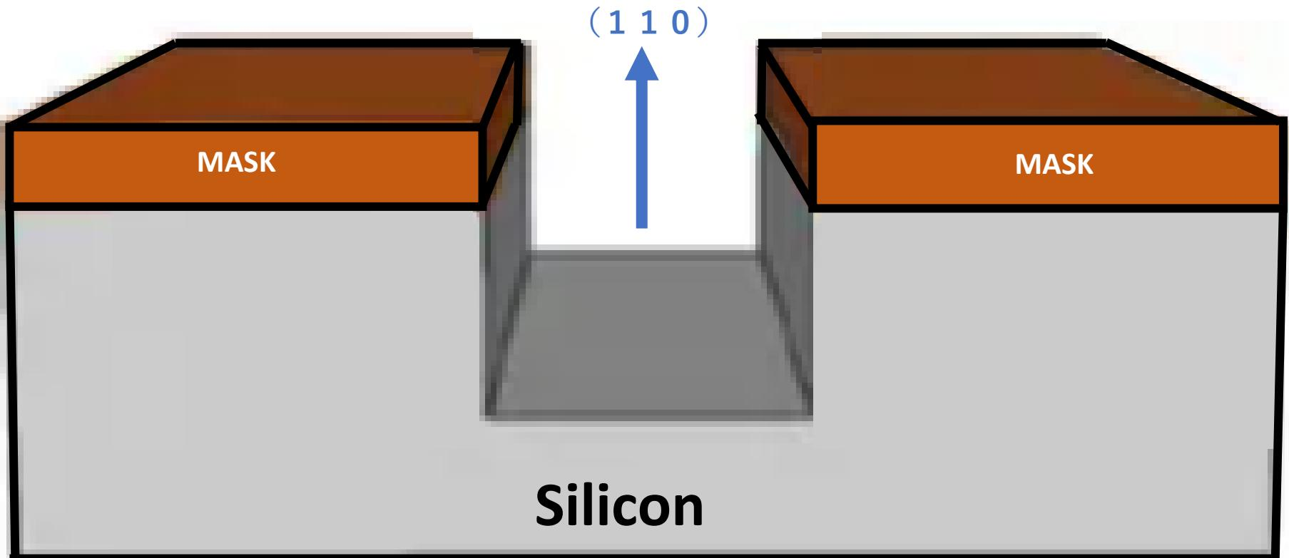
BIPOLAR TRANSISTOR 型ダブル接合太陽電池の生産技術でも KOH液によるSilicon のEtchingが鍵です。
