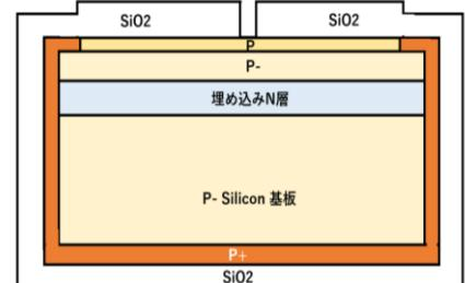
7. **MASK 0 2**：受光表面の酸化膜に、小さな面積のN+領域形成の為のコンタクト窓を開ける。
