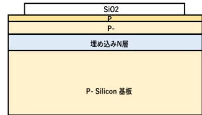
4. **MASK 0 1**：酸化膜を全面に形成し、周辺と側面と裏面の酸化膜は除去する。受光表面となる領域だけ酸化膜を残す。
