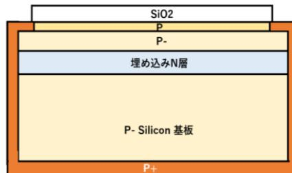
5. 受光表面の周辺領域と側面と裏面の全域に熱拡散で高度の濃いP+領域を形成する。
