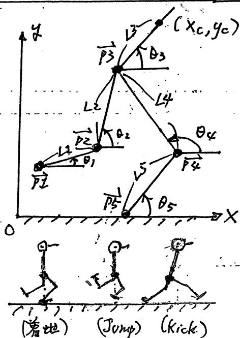
右図は 5 つのリンク (Link) による 脚 (Leg) 構造である。
