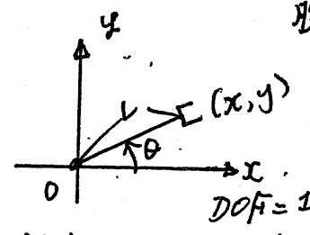
腕の長さが  $L$  (固定)で原点を中心とした  $(x-y)$  平面で回転する
