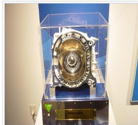
ロータリーエンジンのローター (マツダミュージアム、2005年2月撮影)
