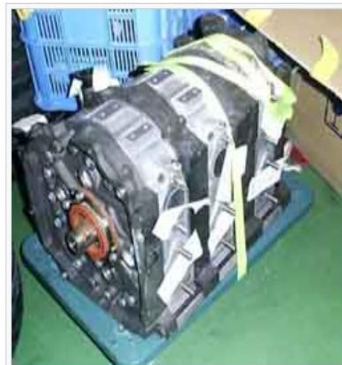
マツダスピード製レース用3ローターエンジン
